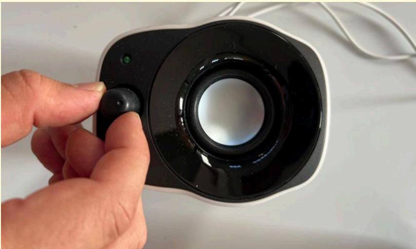
Ajustamos el volumen de los altavoces mediante su potenciómetro frontal
